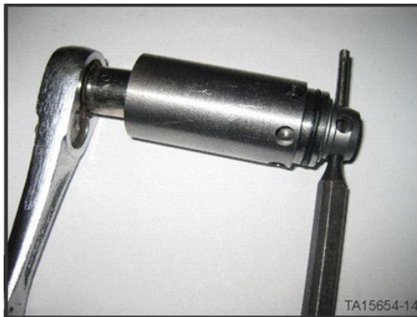
Jam Nut Torque 135 \pm 20 in-lbs ( 1.5 \pm 0.2 daNm)
